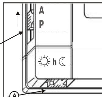
Trascorso il tempo impostato Intellitherm riprenderà il programma automatico. Per ridurre o escludere il periodo JOLLY prima del tempo previsto, azzerare le ore impostate tramite il tasto **A**, oppure spostare il commutatore **S** su una posizione diversa da **A (Automatico)**
